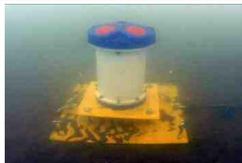
特に定点において、流況を把握したい場合に用いる観測方法です。鉛直方向に、**最小 1cm 間隔**でデータを記録出来ます。また設置可能期間については、データ取得頻度及び電池容量により異なります。なお、設置に関しては流失を防ぎつつ的確なデータを取得する為に、熟練潜水技術者が実施します。
