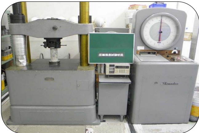
圧縮強度試験
