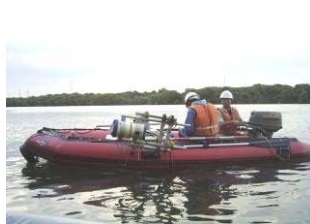
ADCP 流況調査
