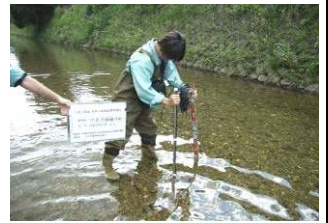
流速測定状況
