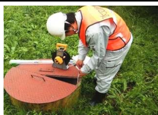
地下水位観測
