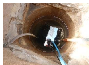
井戸揚水試験
