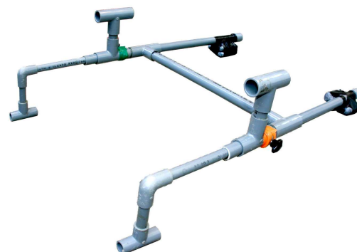
写真2 段差岸壁観察用アタッチメント
